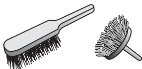
brosses métalliques pour décapage des métaux
